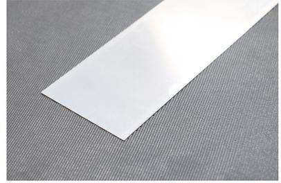
●SK5 MA (焼鈍仕上げ) 冷間圧延後、焼鈍を施し、所定の幅・長さ加工をした材料 単位mm
